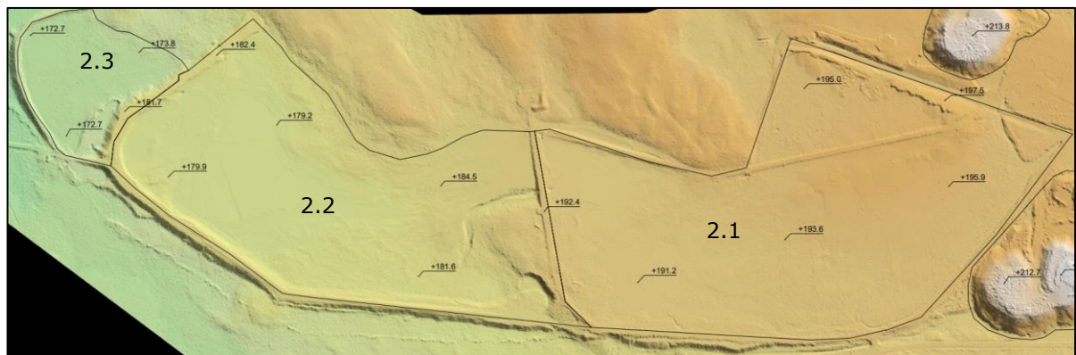
Kuva 7-4. Raajärven rikastushiekka-altaat 2.1 ja 2.2 sekä selkeytysallas 2.3.
