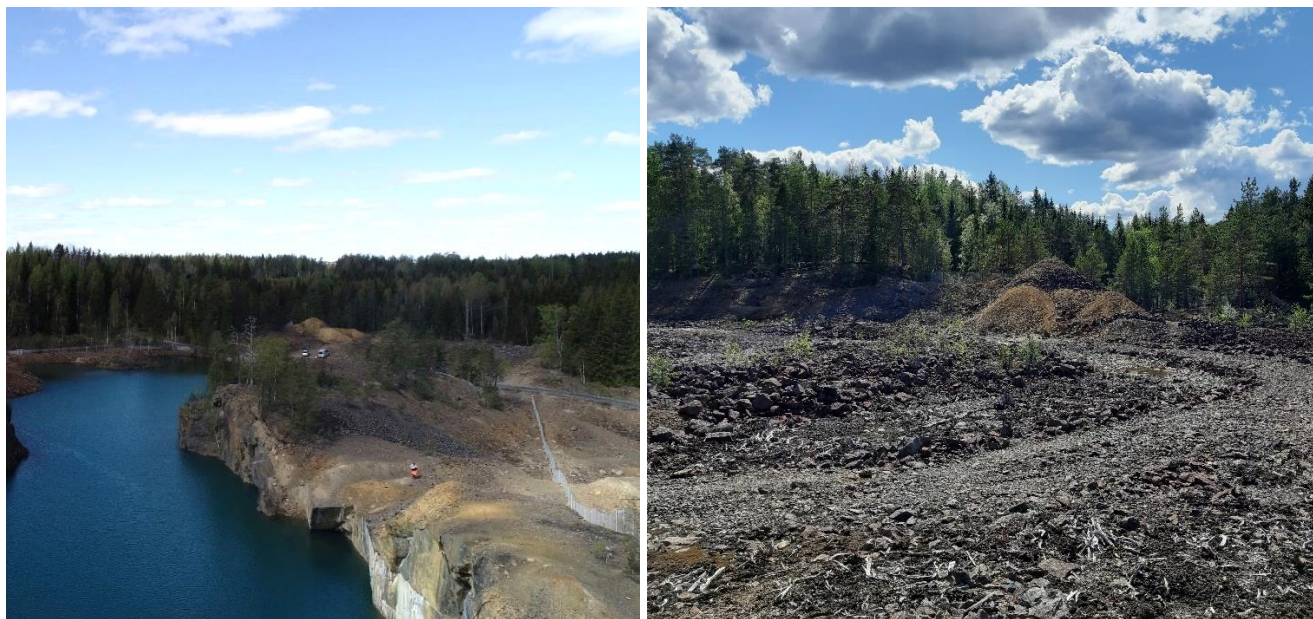
Kuva 5. Avolouhoksen seinämät ovat paikoin jyrkät ja louhosta kiertää yhtenäinen aita (vasemmanpuoleinen dronekuva © T. Lahtinen). Sivukivialue on laaja ja jyrkkärinteisiä kasoja on läjitetty etenkin alueen länsiosaan ja avolouhoksen pohjoispuolelle (oikeanpuoleinen kuva © A. Tornivaara).
